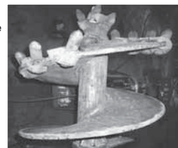
Tornillo sinfín revestido con 2832-MCO
