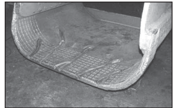
Pala preparada para soldadura de reparación con 3044-FCG.
