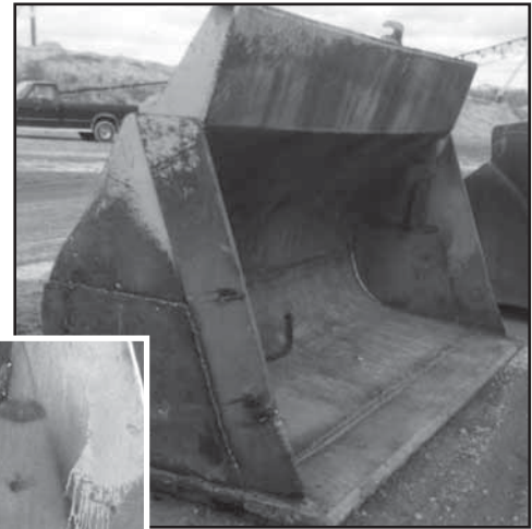
Pala fabricada con 3044-FCG.
