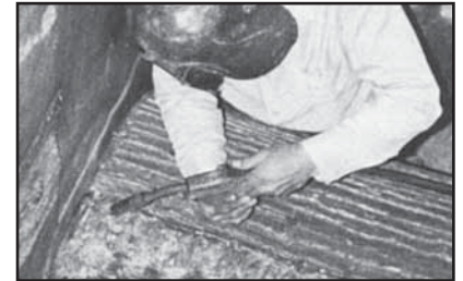
Rodillo de trituración con superficie endurecida con 2820-MCO después de la aplicación de Postalloy 2865-FCO
