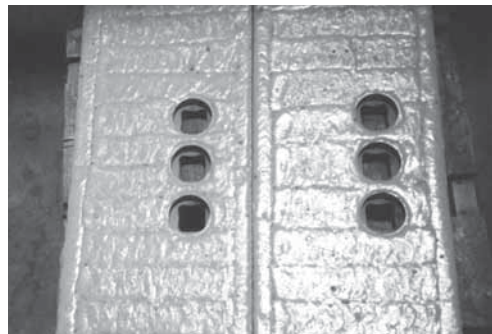
Barrenas de extremo de oruga revestidas con 2836-MCO
