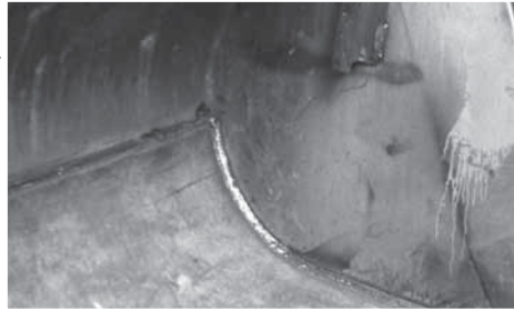
Pala fabricada con 3044-FCG.
