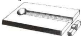
Reparación de grieta con cráter en "V"
