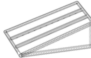
Cordones rectos en paralelo en la dirección de desplazamiento de material rocoso grueso
